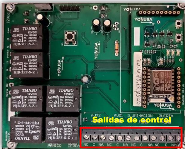
El modulo WIFI se conecta al energizador por medio de conexiones a través de la kulka de ambos dispositivos permitiendo el encendido y apagado del mismo por medio del botón de control en la aplicación, notificando al usuario en tiempo real de la acción realizada desde la aplicación.
