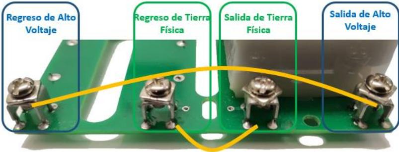
Con esto indicamos que el energizador cumple con la función de alarma y que el energizador no cuenta con ninguna falla en las terminales de salida del alto voltaje del energizador.
