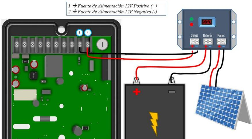
**Nota:** Se recomienda un panel solar de 50 Watts para poder alimentar de forma rápida y eficiente la batería y tenga la potencia suficiente de alimentar el energizador, incluso junto con su sirena correspondiente y una lámpara estrobo.
