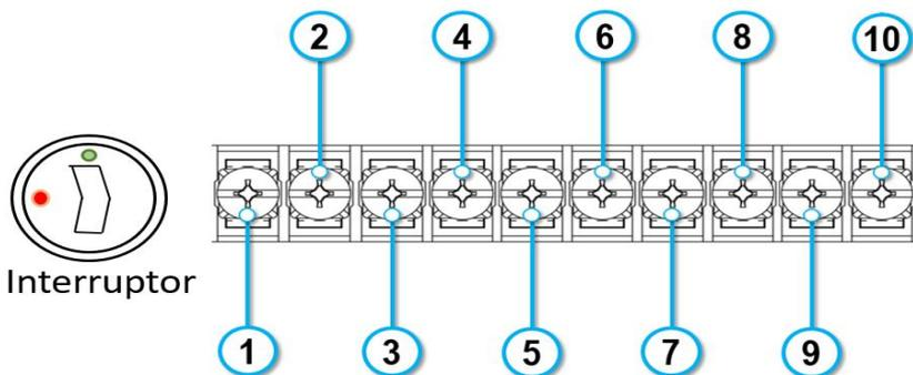
1. **+ Fuente:** Terminal positiva de la fuente de alimentación interna del energizador correspondiente a una alimentación de 12Vcd a 2Amp.
