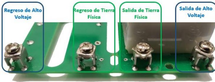
Estas terminales son las que permitirán el paso del alto voltaje realizando las conexiones con el cerco eléctrico, estas terminales cuentan con terminales y tornillo permitiendo manipular de forma sencilla las conexiones al cerco mismo.
