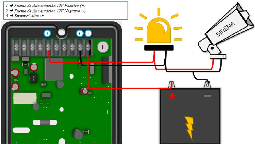
**Nota:** Si se quiere conectar más de una sirena o actuador, se deberá colocar una fuente de alimentación más robusta al equipo, manteniendo el mismo voltaje, pero con una corriente mayor a 2 Amperes.
